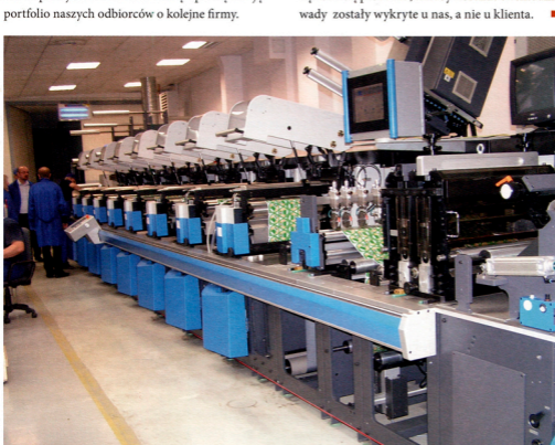
Gallus, który pracuje w Formice, jest wyposażony w system dwukolorowego druku rewersowego i automatycznego czyszczenia wstęgi, posiada automatyczny register oraz możliwość lakierowania w linii. Umożliwia także pracę drukarza: na przenośnym laptopie właściciele drukarni mogą na bieżąco podglądać postęp prac
