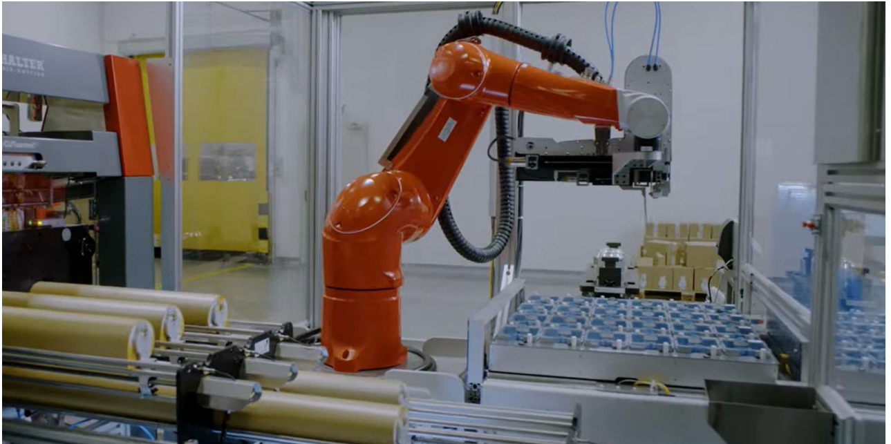
Nowa maszyna wycinająca. Jej wydajność to 130 000 wieczek na godzinę. Fot. Formika
